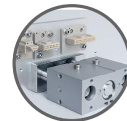
KONTAKTIEREINHEITEN FÜR BATTERIEMANAGEMENT-SYSTEME
